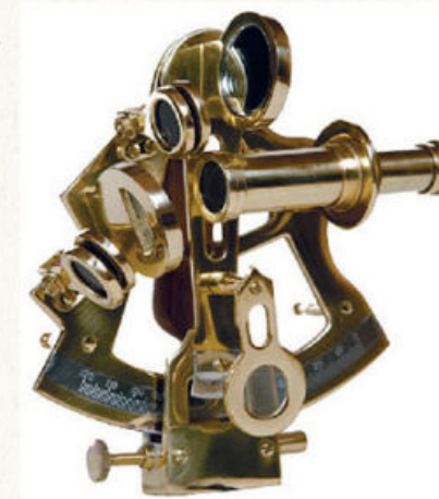
Fig. 4.53 Sextante. Instrumento de medición angular, de gran importancia en la navegación marítima.
